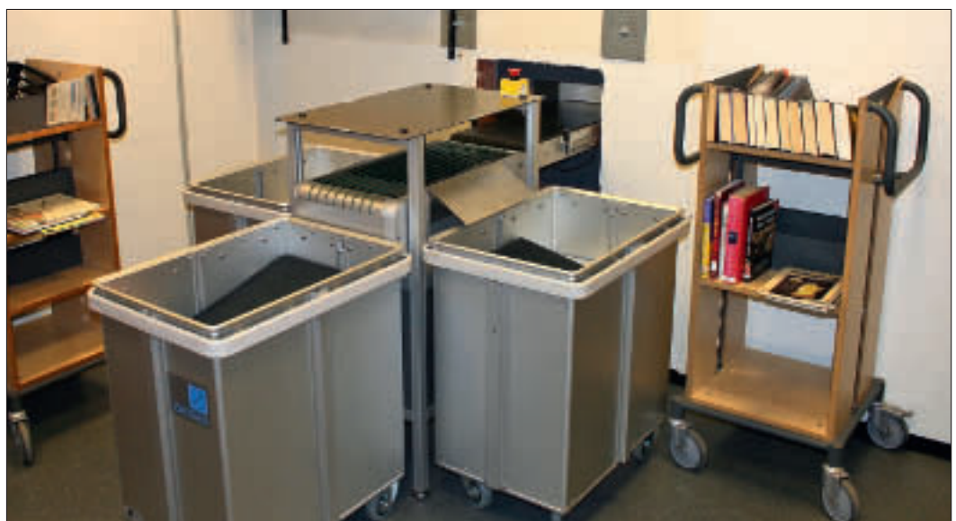
I Gjøvik har de installert Sindre innleveringsanlegg med 3 avkast. Anlegget kan bygges ut modulært med opptil 99 avkast. Det kan nå også settes opp med en tverrforbindelse mellom to Mjølner innleveringsenheter, med samlet sortering på baksiden av vegg. Kombinasjonen Mjølner/Sindre er derfor nå et godt tilbud til både små og store bibliotek. Foto: Bjørn Rune Kristmoen.
